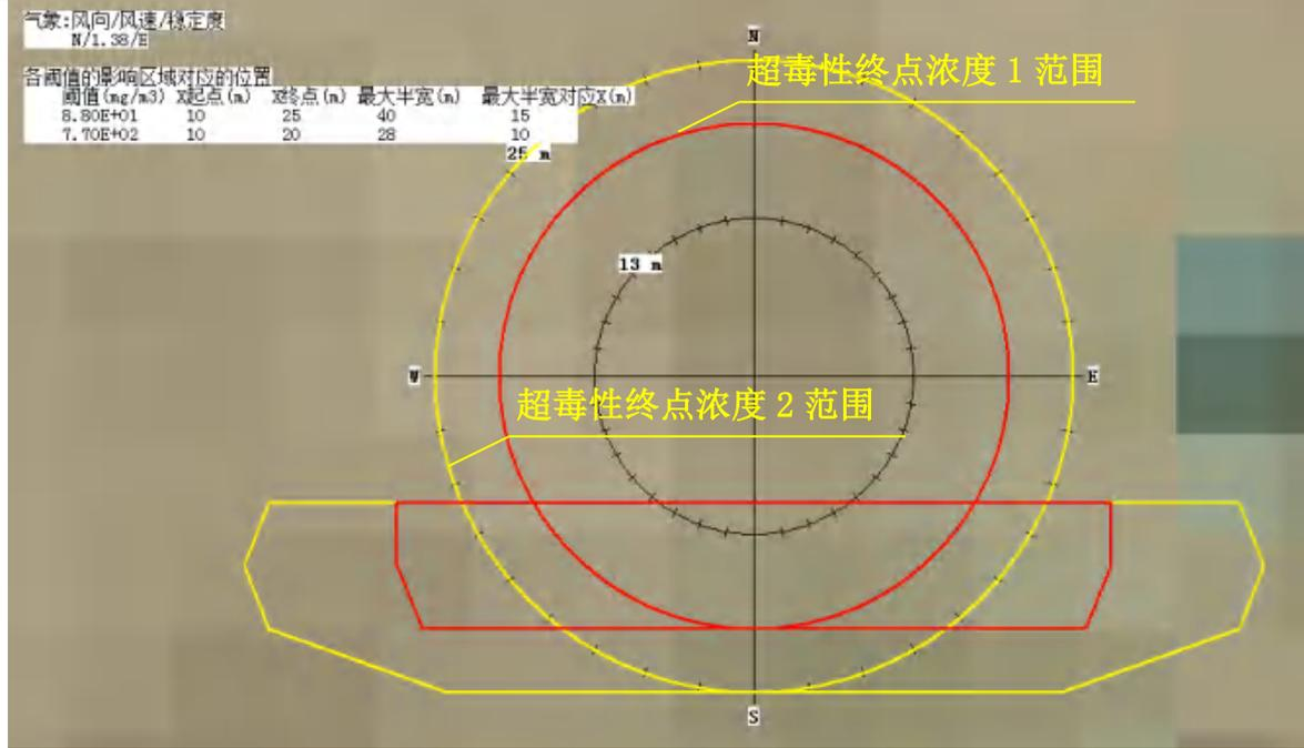
图 8.1-2 最不利气相条件下丙烯酸丁酯储罐外输管道破裂、泄漏事故丙烯酸丁酯影响范围图
