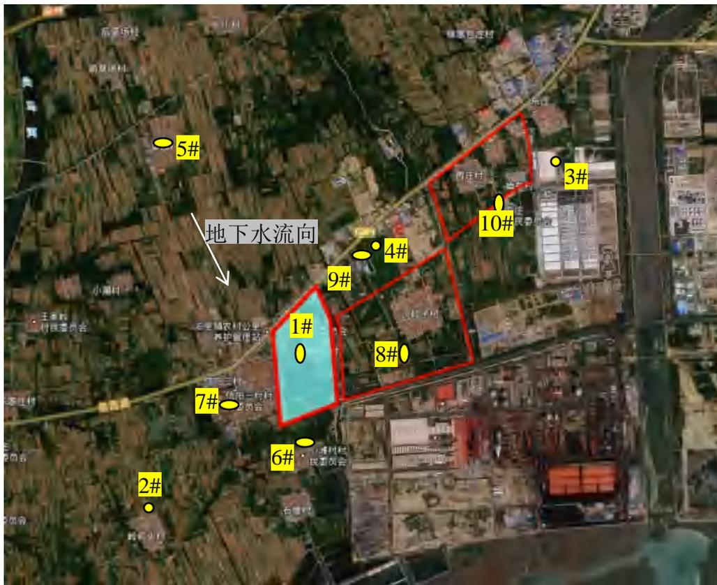
图 5-3 地下水监测点位布置图
