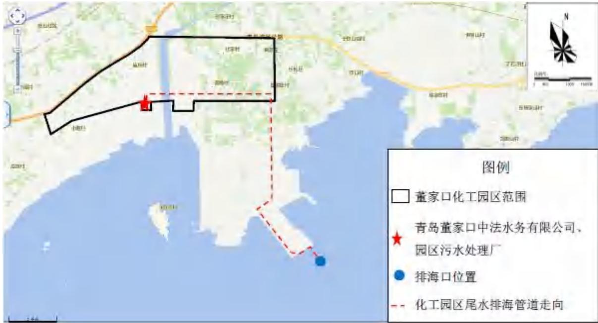
图7.2-1 董家口化工园区规划环评中给出的污水排放管道走向及排污口位置图
